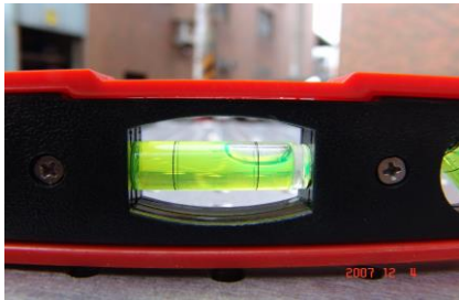
右側過高 需調整右邊腳盤降低 或調整左邊腳盤升高
