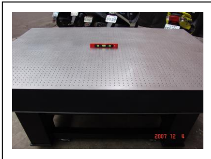
調整 X 方向水平 水平尺放置方式
