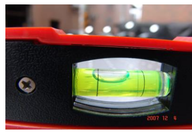
左側過高 需調整左邊腳盤降低 或調整右邊腳盤升高
